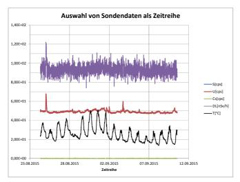
外源计数率 (*C<sub>s</sub>*) 构成。环境辐射强度虽然局部显示出两位数的增加,但显然仍属于正常的环境辐射范围。一般的降雨情况会导致短时间内计数率出现峰值,与此同时外源计数率不会受其影响而随之增加,而是保持在其固有的统计学范畴的噪声水平。除了获取放射源的纯频谱信息以外,探测器可以非常准确地记录辐射场随时间的变化过程。从图中同样可以看到,自然环境辐射的强度不仅受到降雨的影响。例如在晴朗无风的夜晚,降水的影响被排
