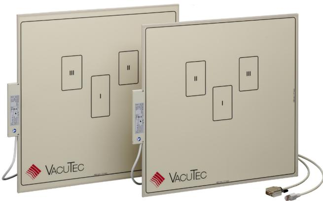
AEC是由内部填充空气的平行腔室组成的电离室, 通常由1个或3个独立的传感区域组成, 并有不同的外形尺寸可供选择。每个AEC电离室都配有前置放大器和电子单元, 可将低电离电流转换为EMC稳定的数字信号。此外, 它还为腔室操作提供电压并允许选择传感区域。
