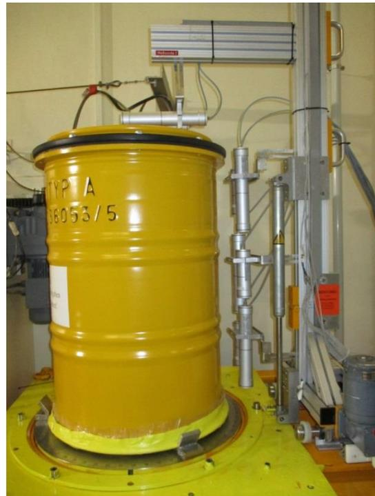
Abb. 3: Links: Aufbau der Sonde VacuTec 70 091, bestehend aus zwei Geiger-Müller-Zählrohren in dünnen Zylindern aus Aluminium, über lange Kabel an die gemeinsame Steuereinheit angeschlossen; rechts: Sonden des Typs VacuTec 70 091 an einem Messplatz zur Bestimmung der Dosisleistungen an Containern mit radioaktiven Abfällen, betrieben von der KTE (Kerntechnische Entsorgung Karlsruhe GmbH, ehemals WAK GmbH).
