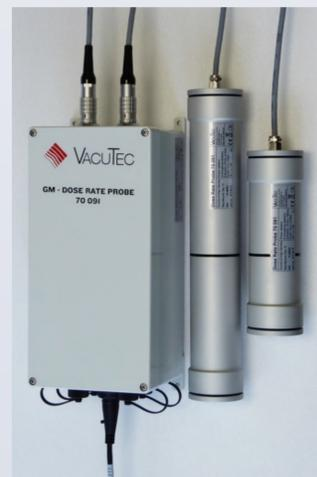
Die GMZ der Sonde sind mit energiekompensierenden Korrektiven ausgestattet und ermöglichen die Messung der Umgebungs-Äquivalentdosis und -Dosisleistung nach den Vorgaben der Norm IEC 60846-1 im Energiebereich von 35-2000 keV (Niederdosis) bzw. 70-4500 keV (Hochdosis).
